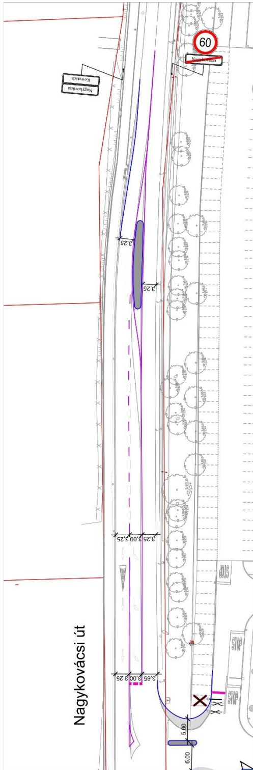
23. ábra Nagykovácsi úti járműosztályozó a középsziget átépítésével vagy áthelyezésével
