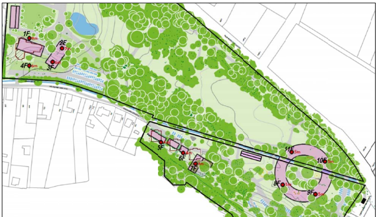
Talajmechanikai fúrások helye és jelzése (forrás: CAN Architects Studio Kft.)
